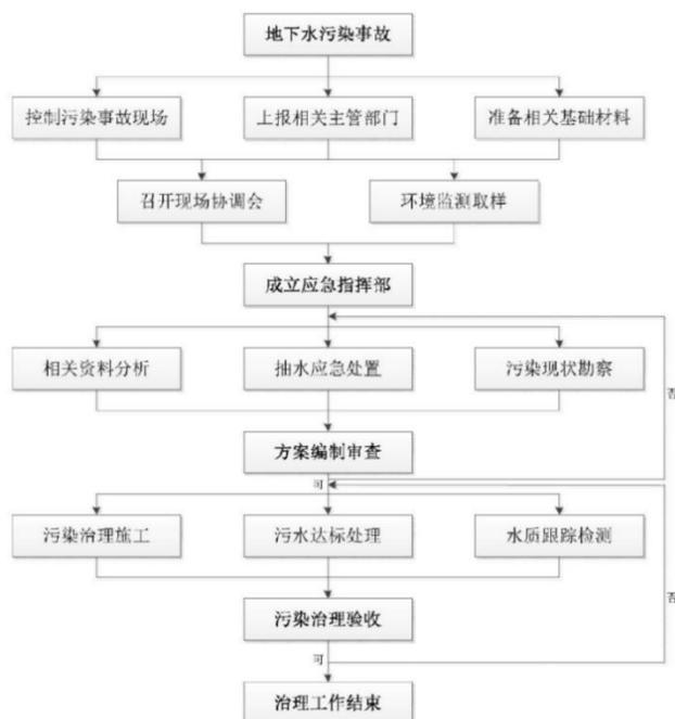
图9.5-3 地下水污染应急治理程序
