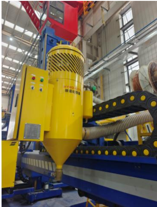
环缝焊接设备自带焊接烟尘处理器
