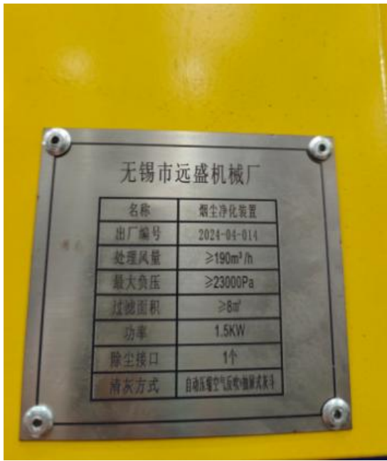
烟尘净化装置铭牌
