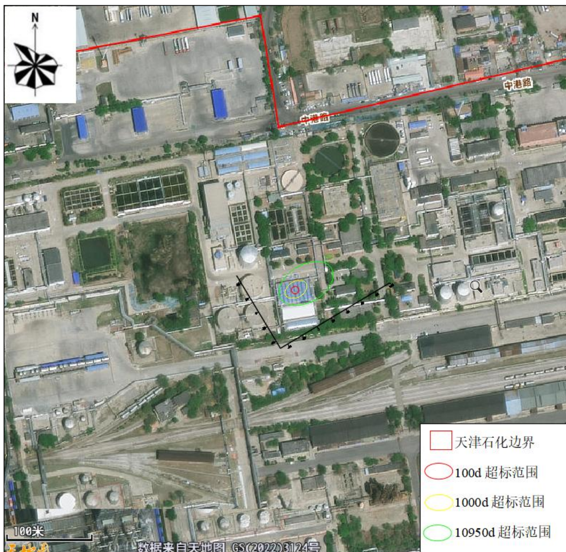
图 6.5-2 渗漏点下游地下水中 COD 浓度超标范围图
